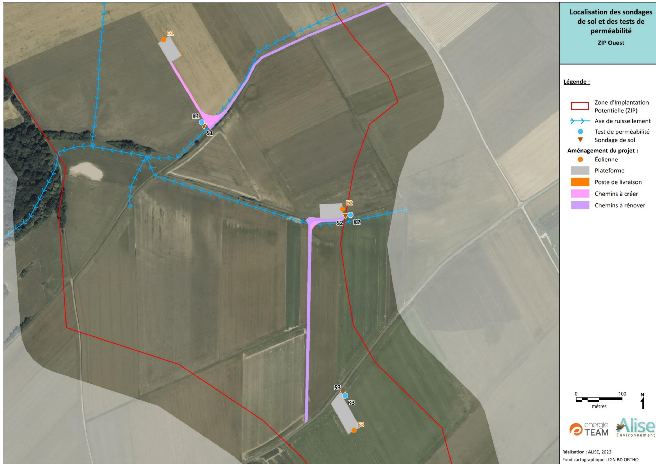
Carte n°9: Localisation des sondages (S) et des tests de perméabilité (K) – ZIP Ouest
